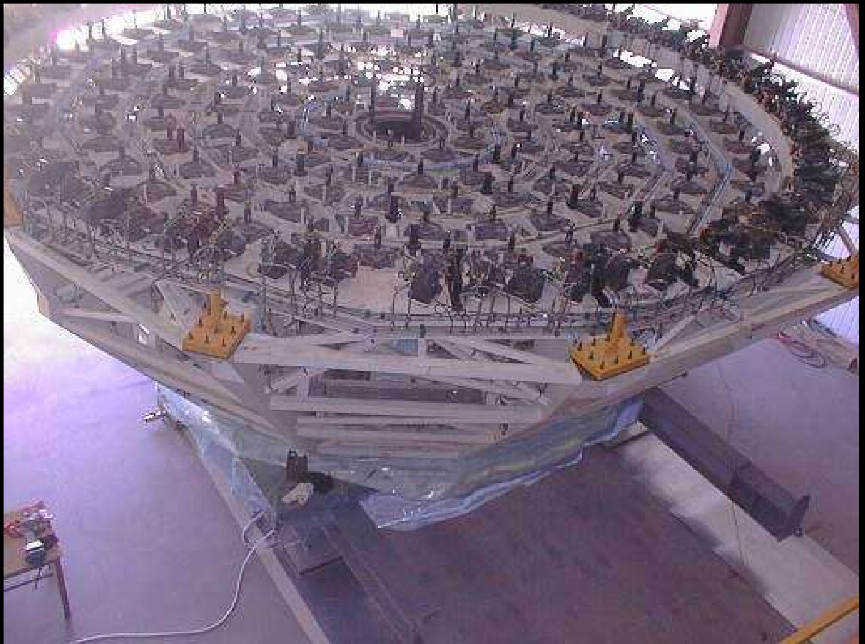
Le barillet d'un des télescopes du VLT, avec ses multiples vérins pour compenser la déformation du miroir principal (optique active)
