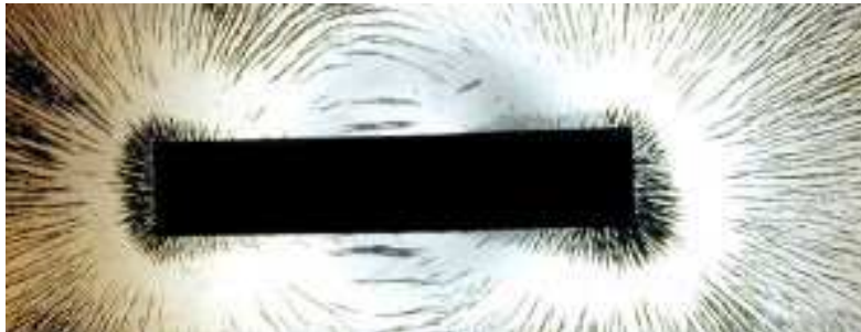
Fig. 6 : visualisation des lignes de champ magnétique d'un aimant par la limaille de fer. ( http://www.palais-decouverte.fr/discip/physique/magnetisme/index.htm )
